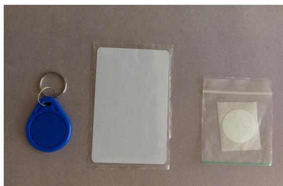
Figura A.1. Etiquetas NFC/RFID
