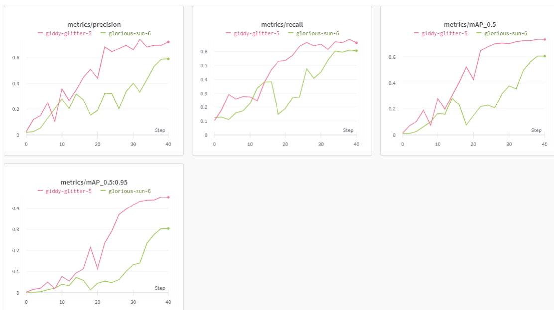
Figura 5.10: Comparación de curva de precisión de la base de datos VeoxDB v1 y v2
